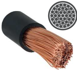
conducteur (compacté) souple (classe 5)
