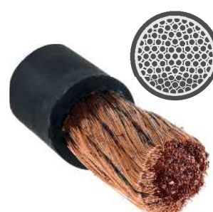
conducteur (compacté) souple (classe 6)
