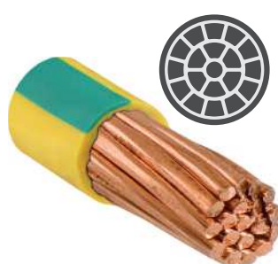
conducteur (compacté) multibrin (classe 2)
